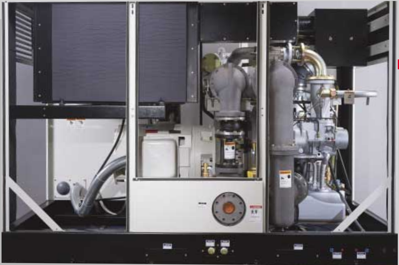
SIERRA-compressor met waterkoeler
