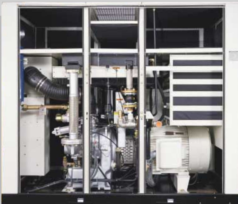
SIERRA-compressor met luchtkoeling
